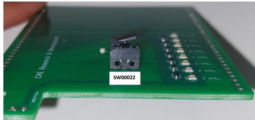
Marca verde indica que la polaridad del LEDS00025 va hacia el lado que no hay linea blanca.
